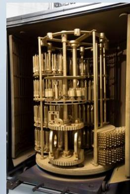
Pièces positionnées sur un carrousel puis placées dans une enceinte sous vide ( $10E-5$  mbar)
