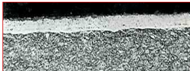
Micrographie d'une couche TENIFER (38CD4 prétraité) agrandissement : 500
