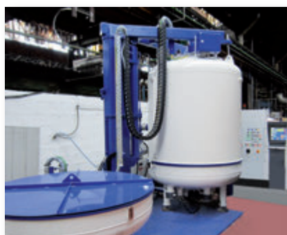
Four de traitement à double embase
